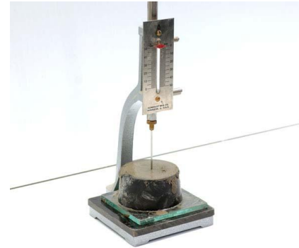
■ Vicat needle Apparatus
