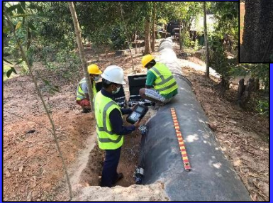
ရွှေလီလမ်းနှင့် ရတနာလမ်းထောင့်ရှိ 160mm Ø HDPE ပိုက်အား ရေစီးဆင်းမှုတိုင်းတာခြင်း
