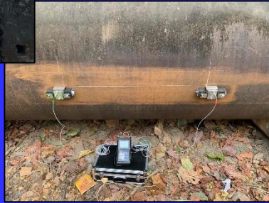
ရွှေလီလမ်းနှင့် ရတနာလမ်းထောင့်ရှိ 160mm Ø HDPE ပိုက်အား ရေစီးဆင်းမှုတိုင်းတာခြင်း
